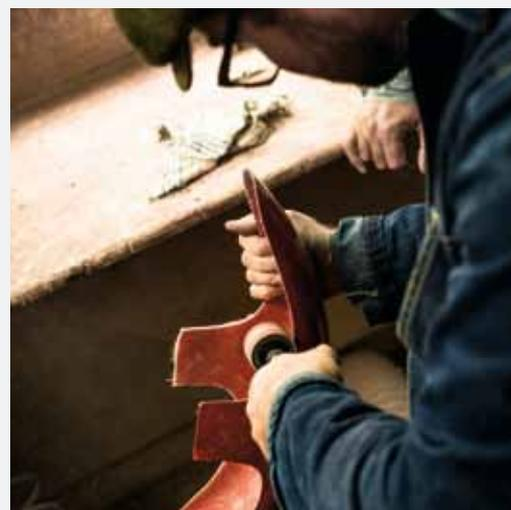
Letzter Arbeitsschritt des Harzens ist das Ausrollen der überflüssigen Menge an Harz mit einer profilierten Rolle. Doch selbst jetzt können Fehler gemacht werden
